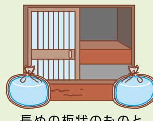
長めの板状のものと組み合わせて止水板に
